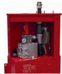
Die Abb. 3.4 und 3.5 zeigen ein schmales Aggregat, welches in der Schachtgrube zwischen den Führungsschienen untergebracht werden kann. Die Steuerung kann außerhalb des Schachtes mit ausreichender Wartungsfläche aufgestellt werden. Die ölfeste Schachtgrube dient gleichzeitig als Ölauffangwanne.
