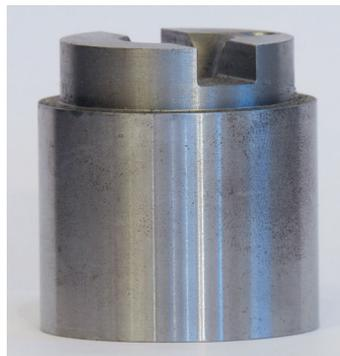
**Bild 4-3.7** Nockenwellenendstück (Stahlsorte: 44SMn28)
