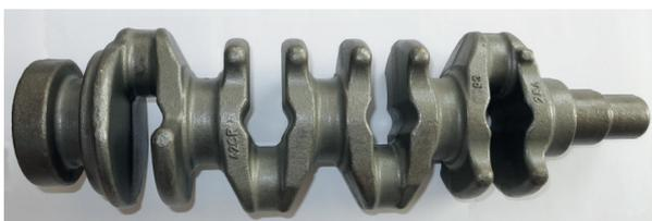
**Bild 4-3.6** Beispiel einer Kurbelwelle (Stahlsorte 42CrMo4)
